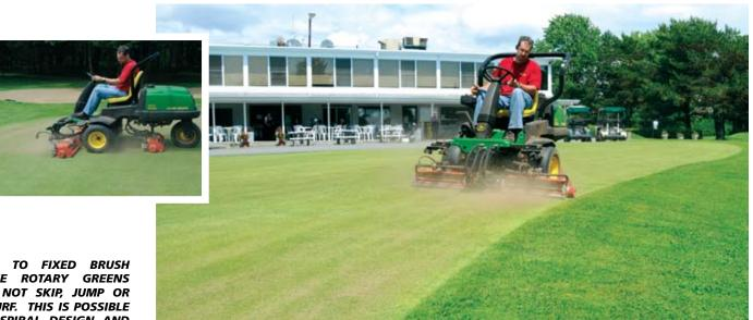
AS OPPOSED TO FIXED BRUSH SYSTEMS; THE ROTARY GREENS BRUSH DOES NOT SKIP, JUMP OR BRUISE THE TURF. THIS IS POSSIBLE DUE TO THE SPIRAL DESIGN AND ROTATION SPEED OF THE BRUSH. FURTHERMORE, THE SPINNING ACTION ALLOWS THE BRUSH TO EVENLY DISPERSE THE SAND EVEN ON SPOTTED TOPDRESSING CONDITIONS.
