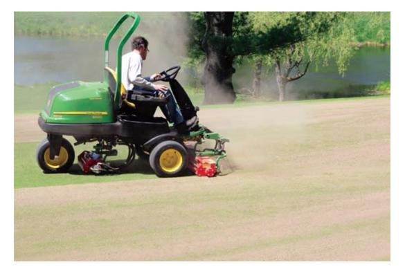
THE AGRIMETAL ROTARY BRUSH ALLOWS YOU TO DEEPLY SETTLE THE SAND IN THE TURF GRASS AS NOT PREMATURELY DULL YOUR MOWER REELS.
