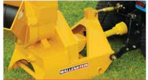
**Transmission à prise de force protégée par boulon de cisaillement**
