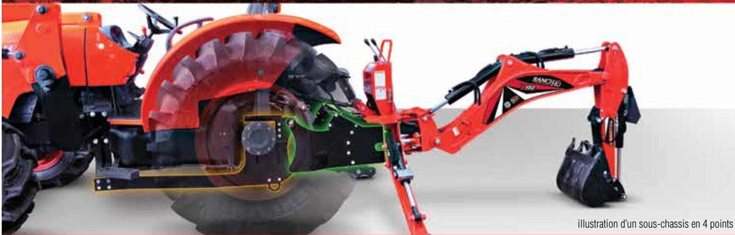
illustration d'un sous-châssis en 4 points
